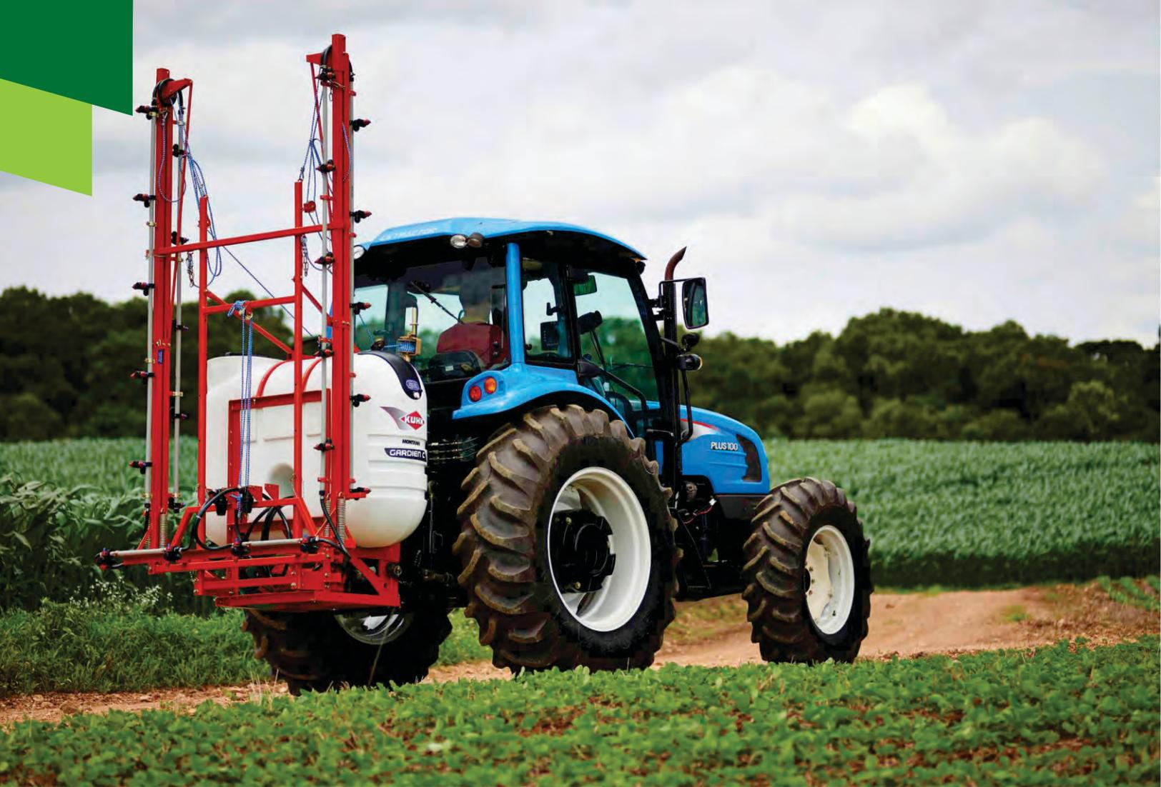
PULVERIZADOR SUSPENDIDO - BARRA
